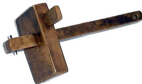
Trusquins, instruments à tracer des lignes parallèles à une surface dressée, en mécanique le socle posé sur un "marbre" de référence, ou en menuiserie.
