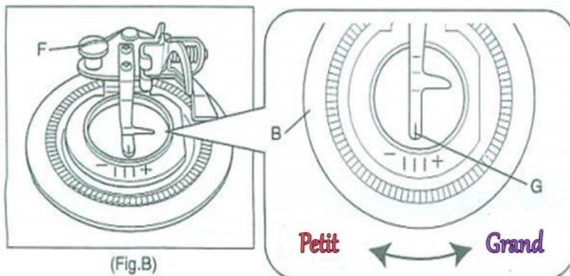
**En déplaçant vers la direction (+) la taille s'élargit et en déplaçant vers la direction (-) la taille se rétrécit (voir fig B).**
