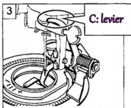
**Relevez le levier C sur la vis de serrage de l'aiguilles.**
