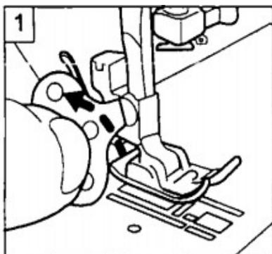
**Retirez le pied de biche et le support du pied de biche en utilisant un tournevis plaque aiguille de vos accessoires standard.**
