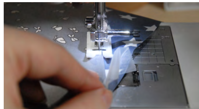
En haut à gauche : placement de morceaux de scotch pour maintenir les pièces entre elles. Attention de ne pas trop appuyer sur le scotch afin qu'il ne soit pas trop difficile à retirer lors de la couture.
