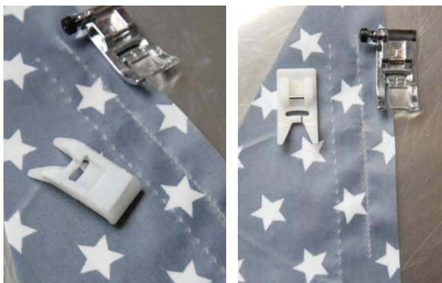
À gauche le pied-presseur avec semelle en téflon (blanc), à droite un pied-presseur normal (métal argenté). A noter la différence de longueur de point obtenue entre les 2 types de pied-presseurs (avec réglages machine identiques). Ce test a été réalisé avec un point long pour vous montrer qu'avec un pied normal, cela « piétine ».
