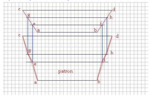
Ce premier croquis est « techniquement » faux …il n'est donné qu'à titre indicatif de la façon de construire l'élément biseau …Cependant ces explications sont conçues pour se calquer sur la construction du biseau H de base …il est parfaitement possible de changer les mesures et de faire , autour du sujet, un biseau qui soit plus haut ou plus bas …
